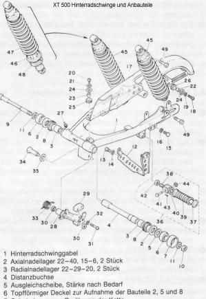
6 Topfformiger Deckel zur Aufnahme der 7 Schutzring gegen Berührung der Kette 8 Dichtung 35–41, 5–8
